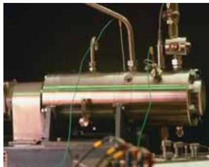
Prüfstand für Blistertests mit hochviskosen Ölen als abzudichtendes Medium
