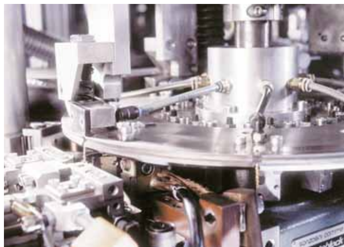
Linearschleifautomat LIN NT 2, vollautomatische Bearbeitung von Kohlebürsten.
