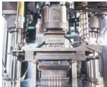
Servo-Spindelpresse, Genauigkeit 0,001 mm.
