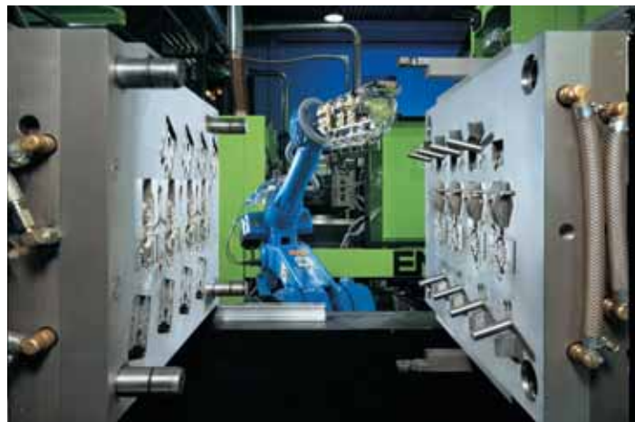
Vollautomatisches Bestückungs- und Umlegehandling zwischen zwei Engel-Spritzgießmaschinen. Herstellung eines Grundmoduls für elektrische Fensterheber mit einer Gesamtausbringung von 2,7 Mio. Teilen.
