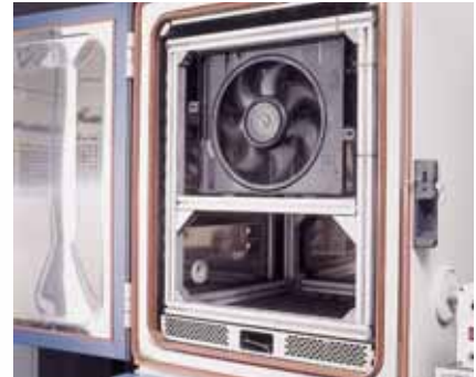
Klimaschrank der Firma Weiss Klimatechnik, (Schunk-Gruppe). Regelbar von 10 bis 95 % Luftfeuchtigkeit, Temperatur einstellbar von -40° bis +180°C.
