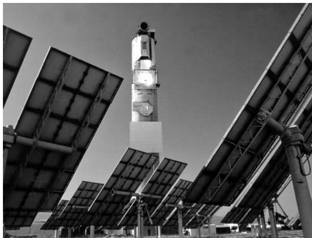
Heliostaten und Turm mit Receiver Heliostats with tower and receiver
