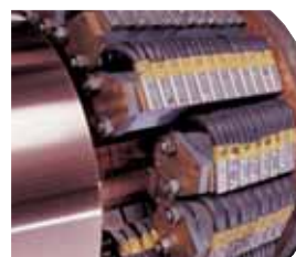
Schunk-Kohlebürsten sorgen für eine Stromübertragung von mehr als 40.000 Ampere
